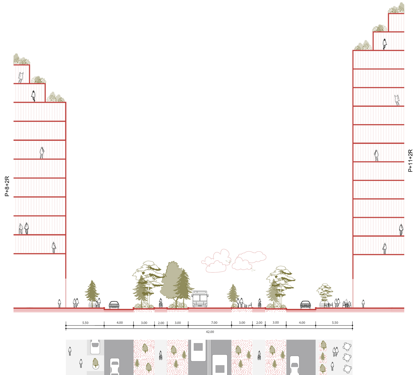
propus Profil stradal A - str. Holdelor 42m
