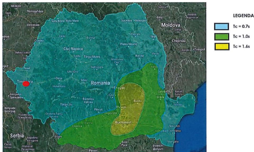
Figură 2 - Harta zonării seismice a României – perioada de colț (Tc), conform P100-1/2013. Punctul roșu reprezintă zona de execuție a lucrărilor geotehnice.
